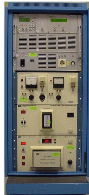
EN 61000-4-5 Surge 4 kV Mains Power, 2.2 kV I/O Cables
